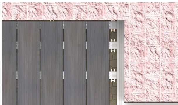
45. Hueco para la colocación lama. Detalle.
