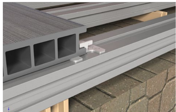
42 Clip y tornillo de acero inoxidable sobre rastrel de aluminio. Testa de tarima apoyada sobre el rastrel.
