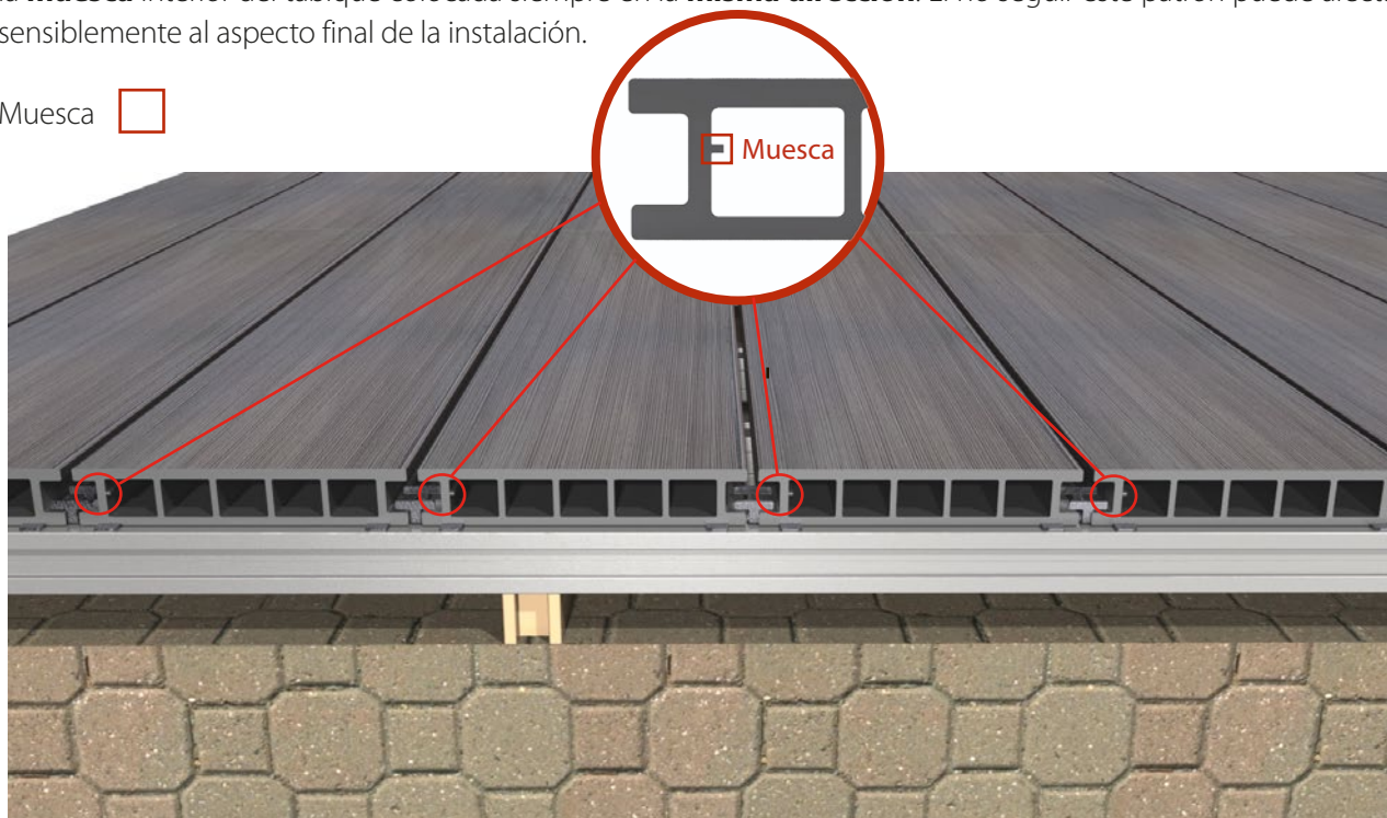
43. Colocación correcta dirección muescas
