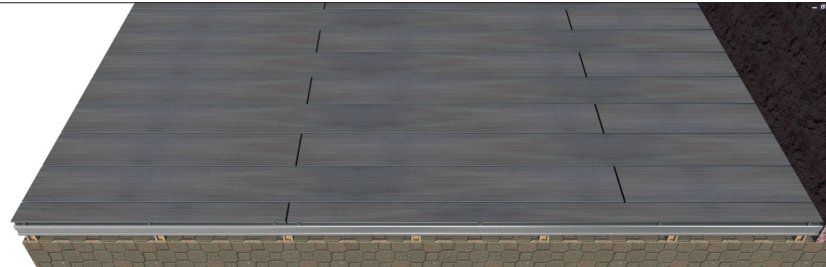
54. Perfil de inicio atornillado sujetando la última tira de lamas.
